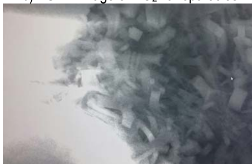
b) SEM image of VO 2 nanoparticles
